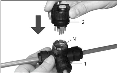
8. Kontaktierelement (2) in SplitConnect Tap (1) einführen; Ausrichtung ist durch Nut (N) und Führung im Kontaktierelement (2) vorgegeben.
