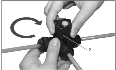
9. Kontaktierelement (2) bis auf Anschlag anziehen. Zur Unterstützung kann ein Schraubendreher durch die dafür vorgesehene Öffnung im Kontaktierelement (2) gesteckt werden.
