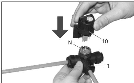
SplitConnect Terminator (Ex) (10) in SplitConnect Tap (1) einführen. Ausrichtung ist durch Nut (N) und Führung im SplitConnect Terminator (Ex) (10) vorgegeben. **Achtung!** Alle 3 Abgänge müssen korrekt bestückt sein.
