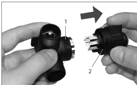
1. Kontaktiererelement (2) losschrauben und von SplitConnect Tap (1) abziehen.
