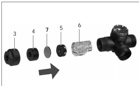
Ein **nicht benutzter Ausgang** wird mit Mutter (3), Dichtung (4), **Dichtscheibe (7)**, Schirmkontaktier-element (5) und Litzenhalter (6) abgeschlossen (Reihenfolge beachten).
