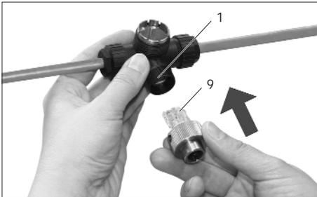
1. SplitConnect M12 Outlet (9) auf einen freien Leitungsabgang eines SplitConnect Tap (1) aufschrauben.
