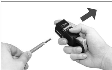
2. Leitung mit FastConnect Stripping Tool <sup>1)</sup> absolieren.
